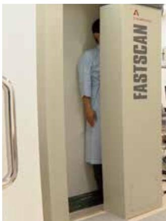
また、1階にはホールボディカウンターを設置し、内部被ばくの線量評価が行えます。
