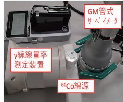
図 1  $^{60}\text{Co}$  線源による  $\gamma$  線照射実験風景
